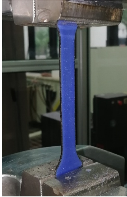
Figura 40: Prova di trazione statica provino smaltato
