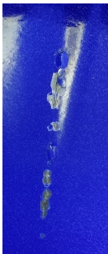
Figura 24: Salto smalto virola lontano da saldatura longitudinale
