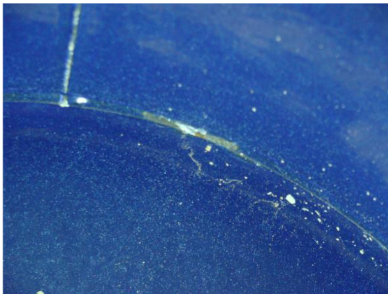
Figura 17: Salto smalto saldatura circonferenziale
