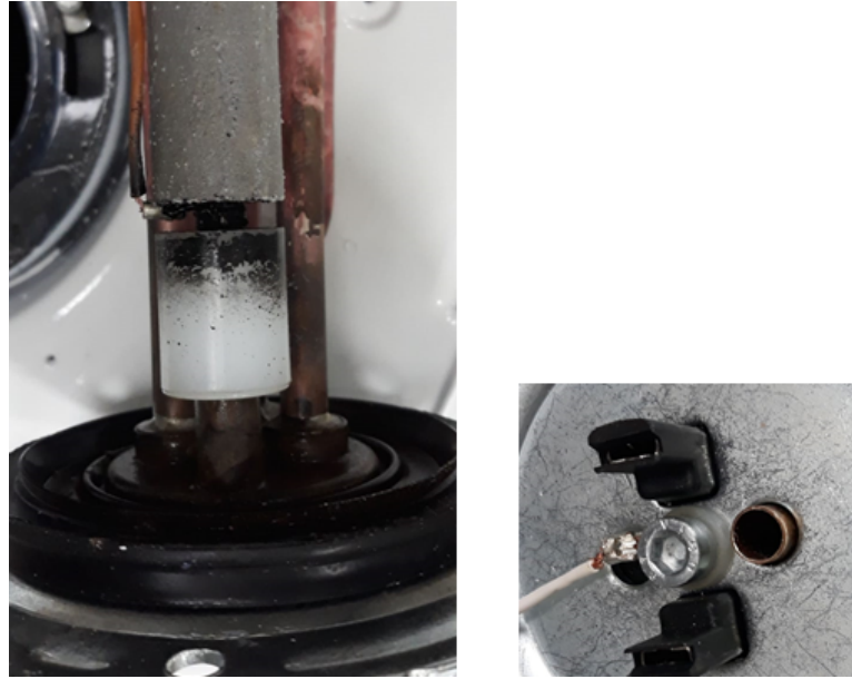
Figura 43: Dettaglio inserti isolanti
