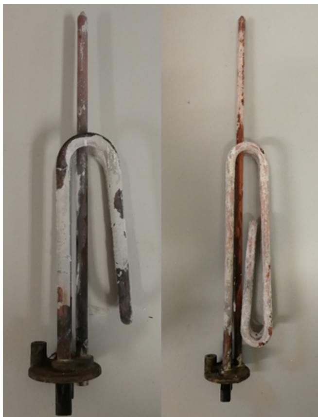
Figura 45: Resistenze elettriche 1200W e 3000W
