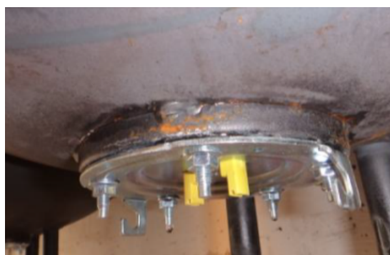
Figura 21: Punti di rinforzo controflangia
