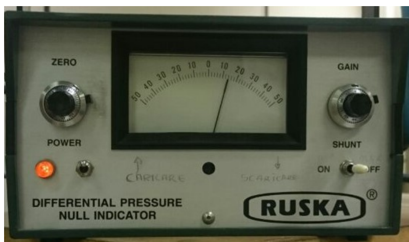
Figura 6.8 Particolare del misuratore di pressione differenziale.
