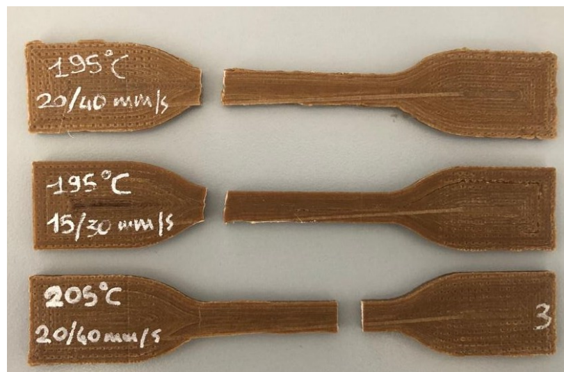
Figura 30: Rottura in corrispondenza delle teste dei provini in Hemp-PLA
