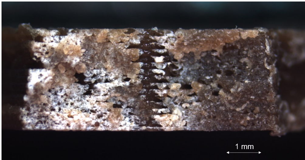
Figura 32: Vuoto dovuto alla modalità di stampa nel provino di Hemp-PLA 2 (12,5x)
