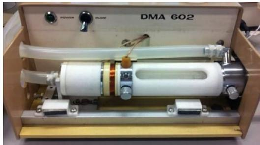
Figura 1.14: Densimetro a tubo vibrante [32]
