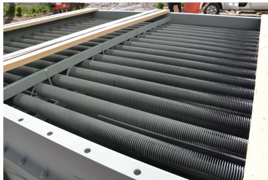
Figura 1.24: Scambiatore a tubo alettato [48]
