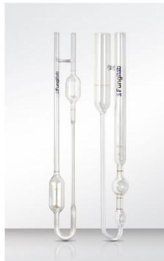
Figura 1.20: Viscosimetro capillare [41]
