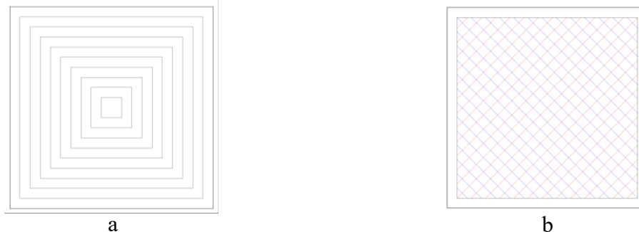
Fig. 4.1 Trama di riempimento concentrica (a) e rettilinea (b)
