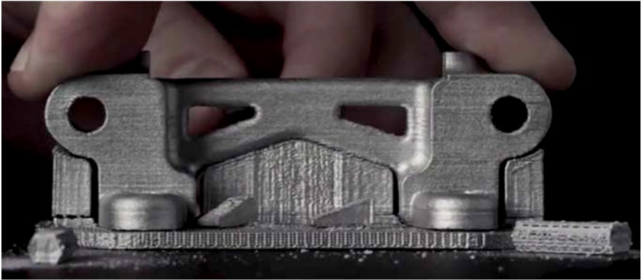
Fig. 3.16 Parte sinterizzata con supporto
