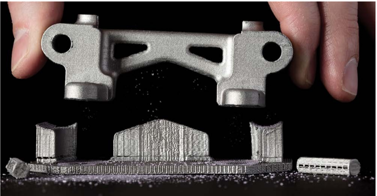
Fig. 3.17 Parte sinterizzata al distacco dal supporto
