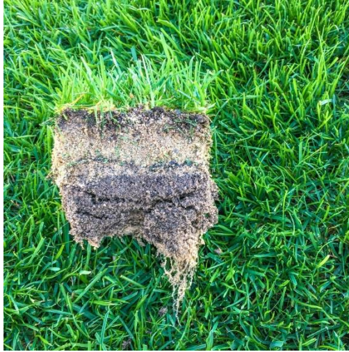
Figura 5. Zolla del tappeto erboso dello stadio di San Siro, appartenente alla categoria del tappeto erboso naturale ibrido realizzato con la modalità della cucitura delle fibre su tappeto naturale
