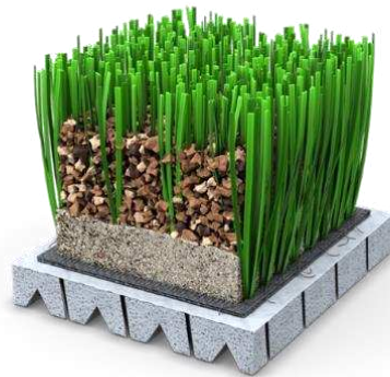
Figura 6. Profilo di tappeto erboso sintetico ibrido, composto da intaso prestazionale di granulato di sughero e fibre sintetiche
