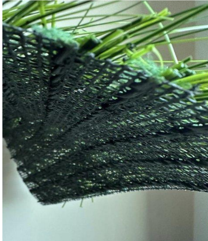
Figura 2. Tappeto erboso naturale rinforzato dove è evidente la rete sintetica
