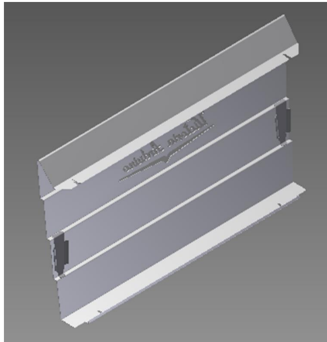
Figura 3.5 – Modello CAD del componente carena retro della macchina da caffè VA358
