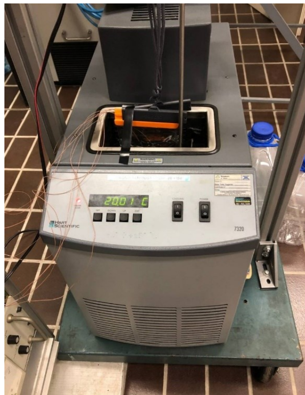
Figura 21 : Immersione delle batterie nel bagno termostatico
