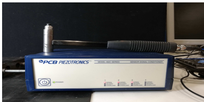
Figura 3.2.: Condizionatore di segnale
