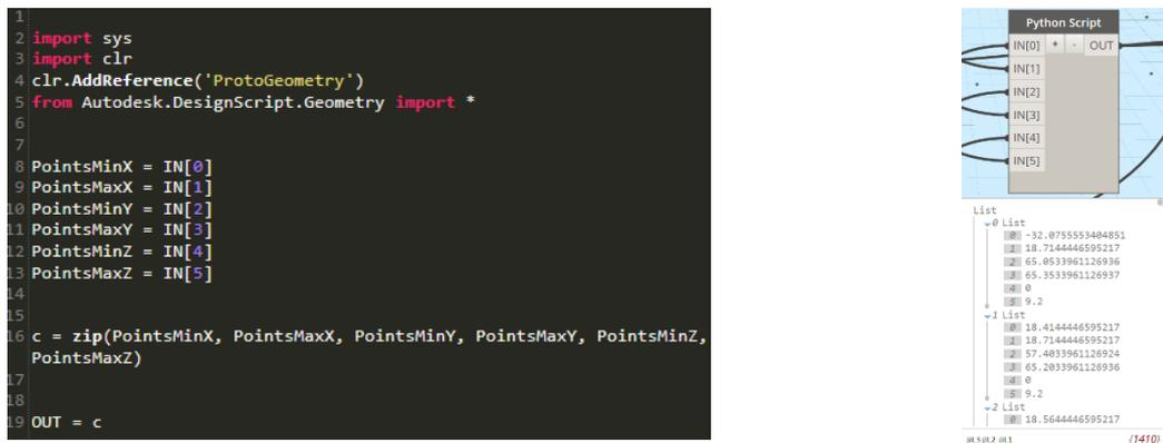
Fig. 64 - Dynamo: script per la combinazione delle coordinate dei vertici degli elementi
