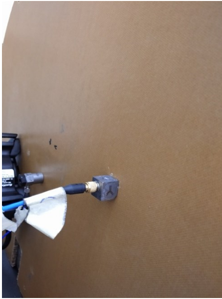
Figura 64 – Particolare accelerometro triassiale
