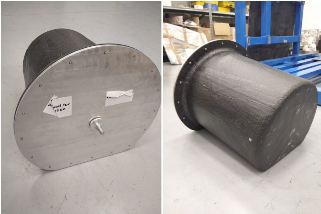
Figura 22 – Prototipo in fibra di carbonio con piastra in acciaio
