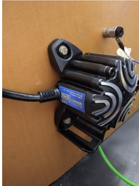
Figura 63 – Particolare dello shaker e accelerometro sul pannello
