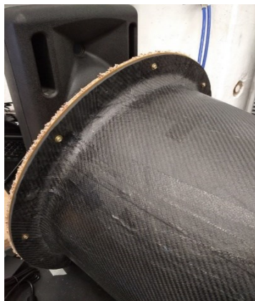
Figura 58 – Particolare serraggio del pannello
