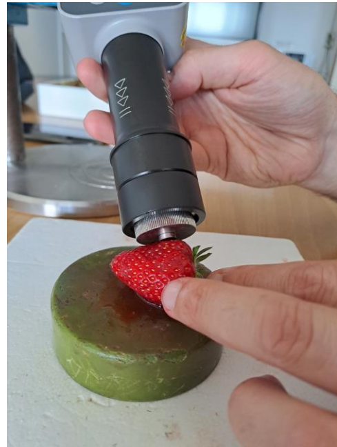
Figura 13 - Effetto del puntale da 0.5 cm 2 del Durometro su fragola.
