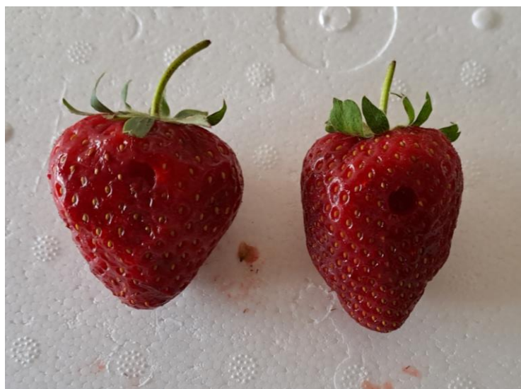
Figura 15 - Effetto puntale a stella da 6 mm del Penetrometro su fragola
