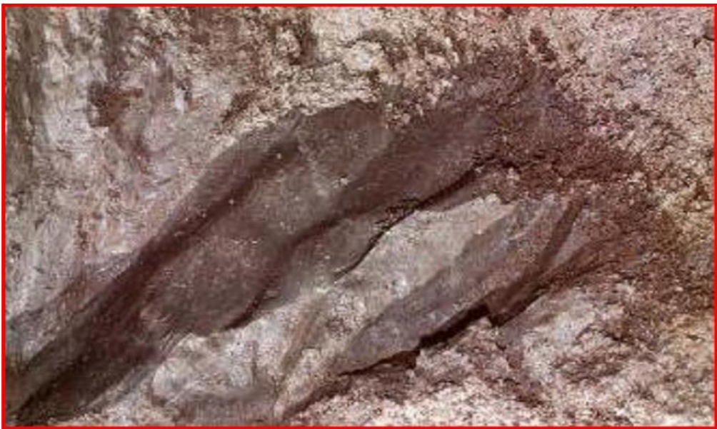
Esempio di slickensides formatasi sui margini di una frattura.
