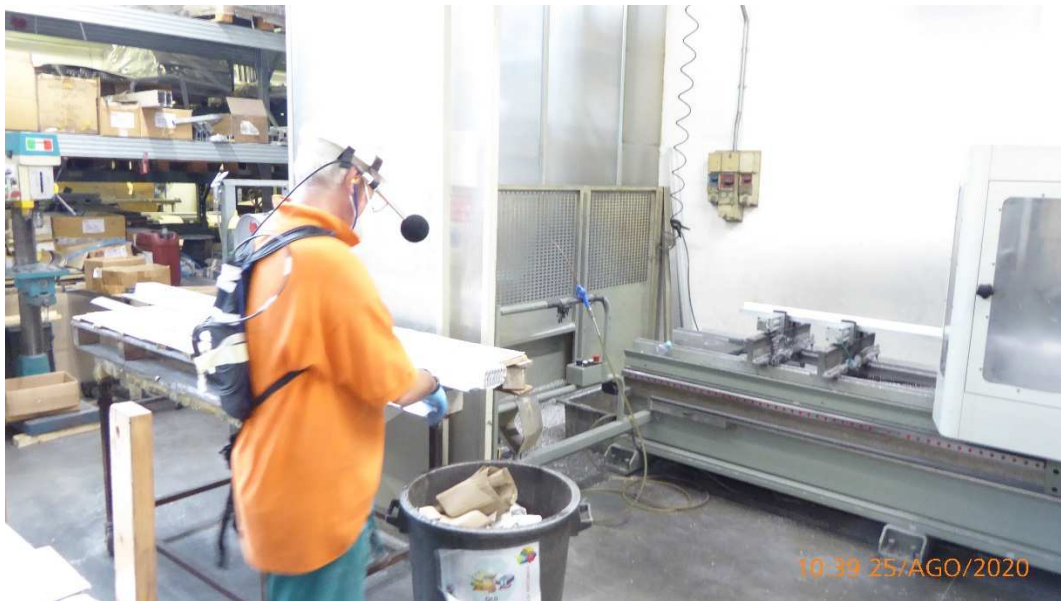
Figura 32 - Mansione 3, Compito 3.1, Gestione del CL3 EMMEGI SATELLITE XL per la finitura di estrusi e pulizia finale dai residui con pistola ad aria compressa (al centro in blu nella foto)
