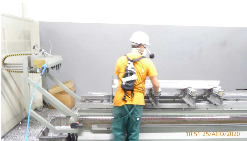
Figura 34 - Mansione 4, Compito 4.1, Gestione CL1 per finitura automatizzata di estrusi anodizzati e pulizia dai residui con pistola ad aria compressa (in azzurro a sinistra nella foto)
