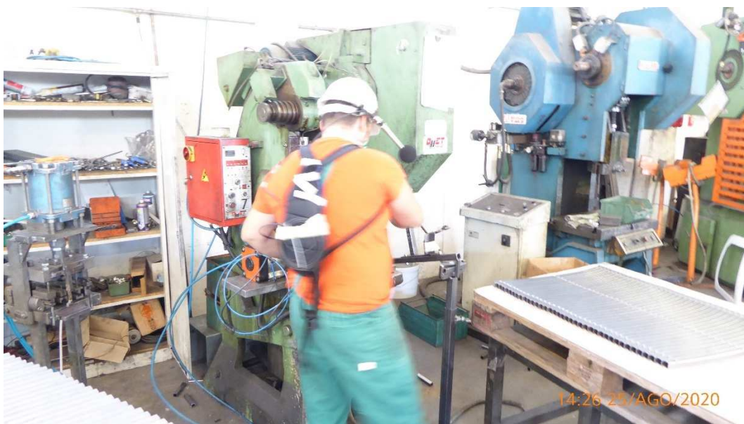
Figura 26 - Mansione 2, Compito 2.5, Presse ad aria compressa OMET
