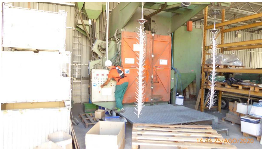
Figura 28 - Mansione 2, Compito 2.6, Granigliatura di tubi su grucce usando una decalaminatrice
