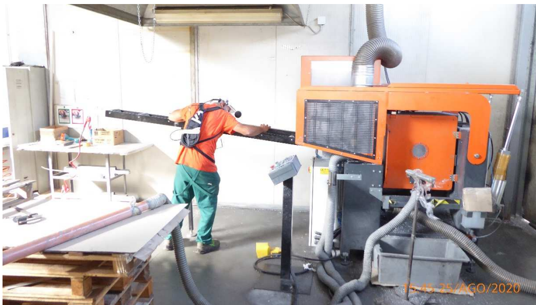
Figura 42 - Mansione 5, compito 5.3, Scantonatrice usata per lo smussamento di 7 pezzi
