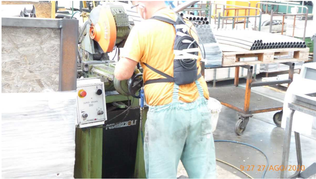
Figura 48 – Mansione 6, Parte del compito 6.1, breve taglio di un tubo con sega a disco PEDRAZZOLI
