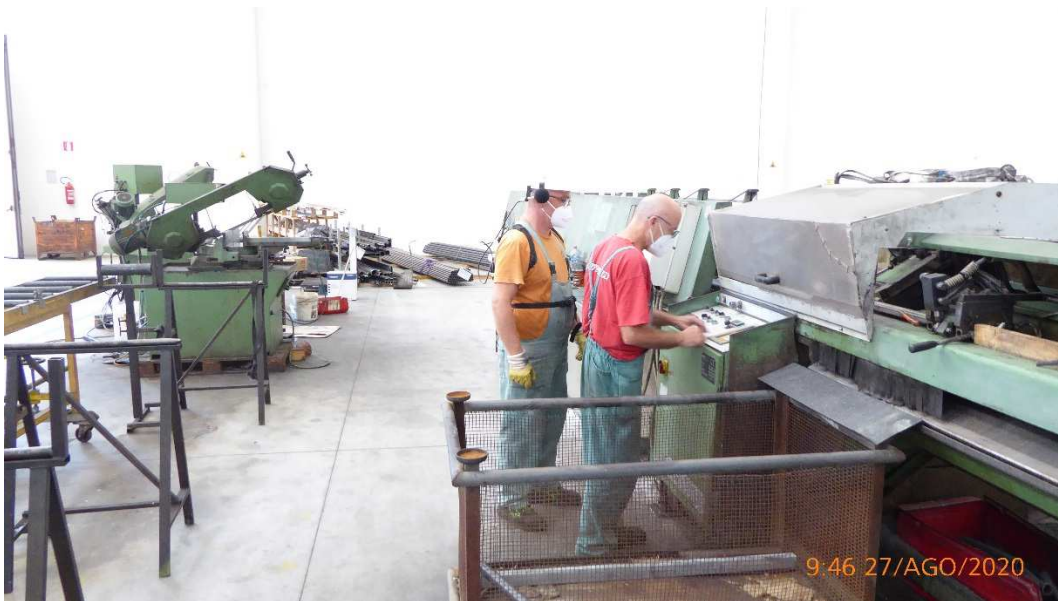
Figura 51 - Mansione 6, compito 6.4, Troncatrici in contemporanea attività. A destra una ADIGE SALA TT640, a sinistra una PEDRAZZOLI BROWN SN320
