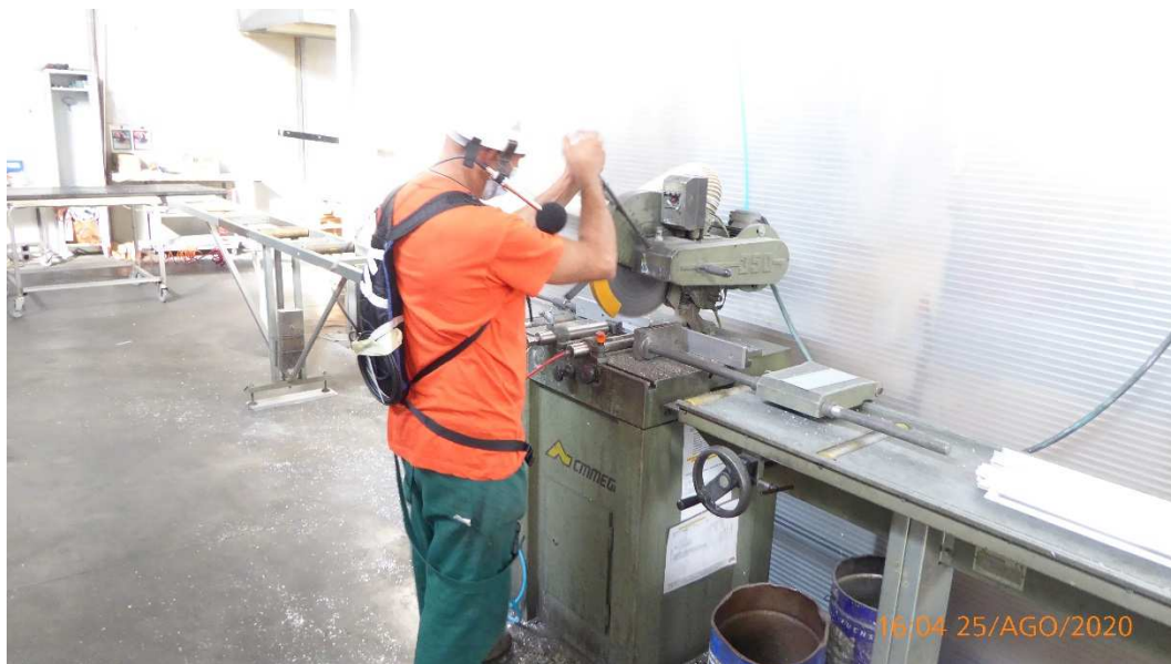
Figura 46 - Mansione 5, compito 5.5, Sega EMMEGI 350 a disco fissa a una testa a comando manuale, effettuata misurazione di 30 tagli
