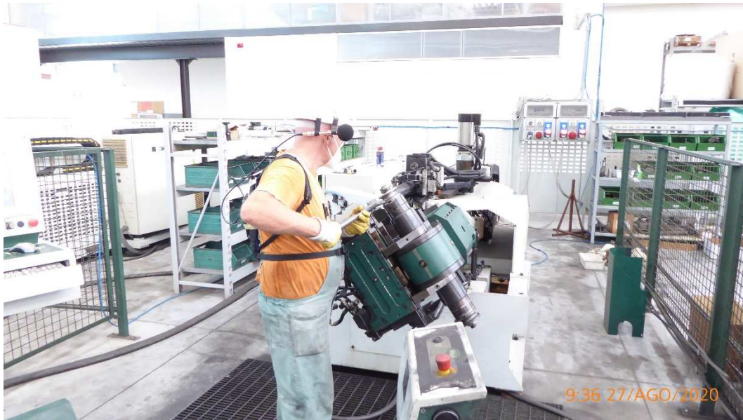
Figura 50 - Mansione 6, compito 6.3, Piegatubi a bagno d'olio BLM SWING Ø25-30
