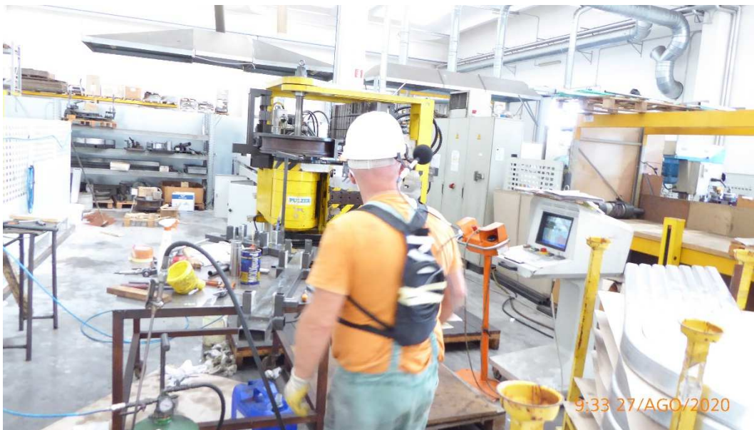
Figura 49 - Mansione 6, compito 6.2, Piegatubi idraulica PULZER Ø80
