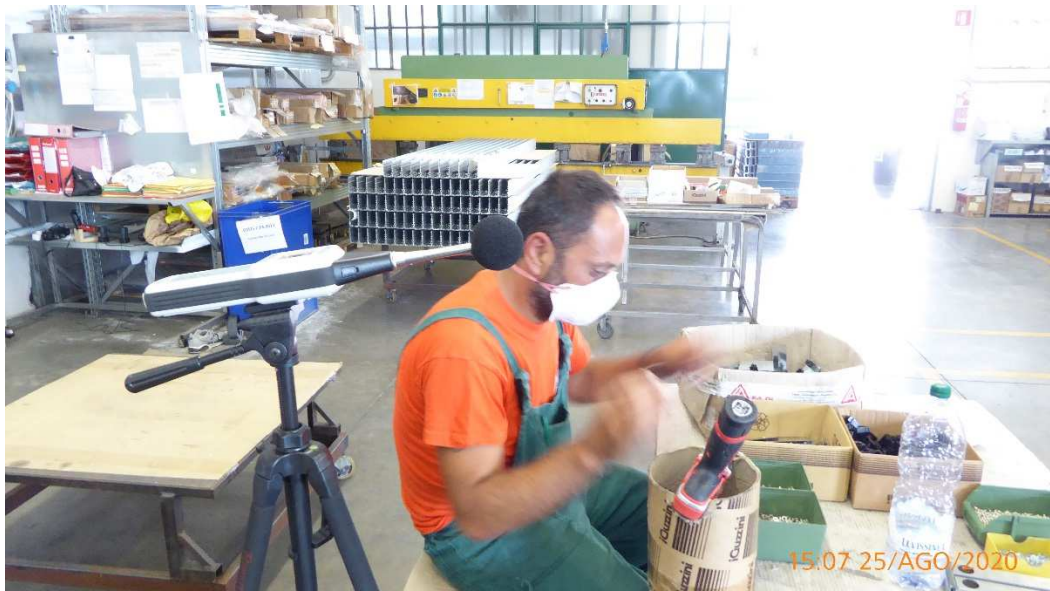
Figura 38 - Mansione 5, compito 5.1, Pre-assemblaggio di piccoli componenti, data la posizione seduta del lavoratore intento ad avvitare con un avvitatore elettrico delle placchette, si è optato per l'uso del treppiede all'altezza dell'orecchio
