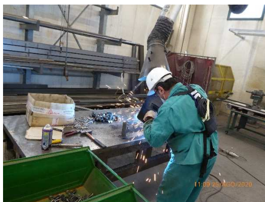
Figura 21 - Mansione 2, Compito 2.2, Saldatura di alcune staffe
