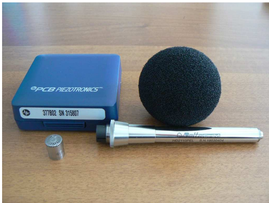
Figura 6 - A sinistra il microfono 377B02 della PCB Piezotronics con numero seriale 315807, a destra l'antivento in spugna e il preamplificatore HD2110PEL della Delta OHM con numero seriale 19030404
