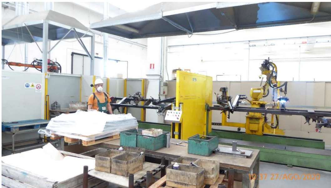
Figura 53 - Mansione 7, compito 7.1, controllo del robot saldatore FANUC ARC MATE 100i
