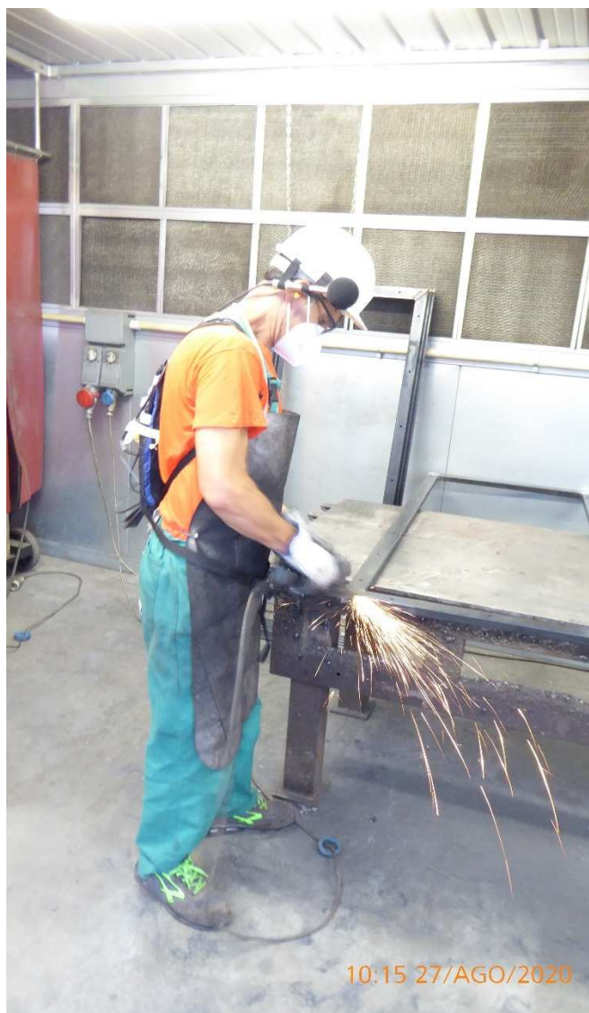
Figura 30 - Mansione 2, Compito 2.7, Molatura di alcuni telai (compito svolto nello stabile nuovo)
