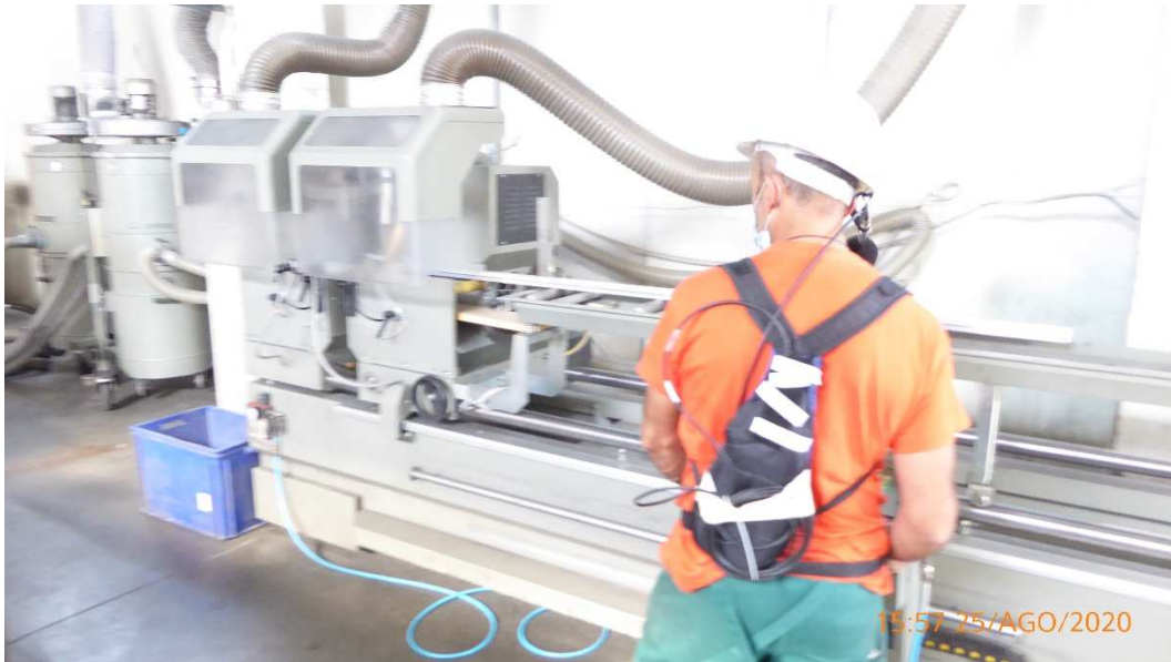
Figura 44 - Mansione 5, compito 5.4, Taglio di 2 o 3 estrusi con sega EMMEGI a disco automatica a doppia testa
