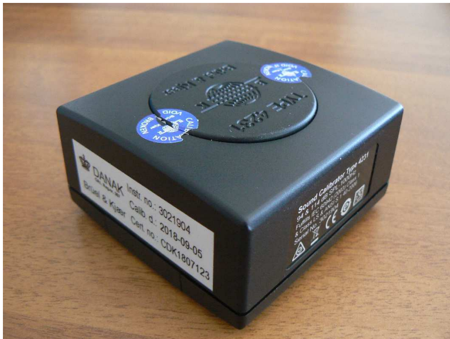
Figura 7 - Calibratore acustico Sound Calibrator Type 4231 della Brüel & Kjær
