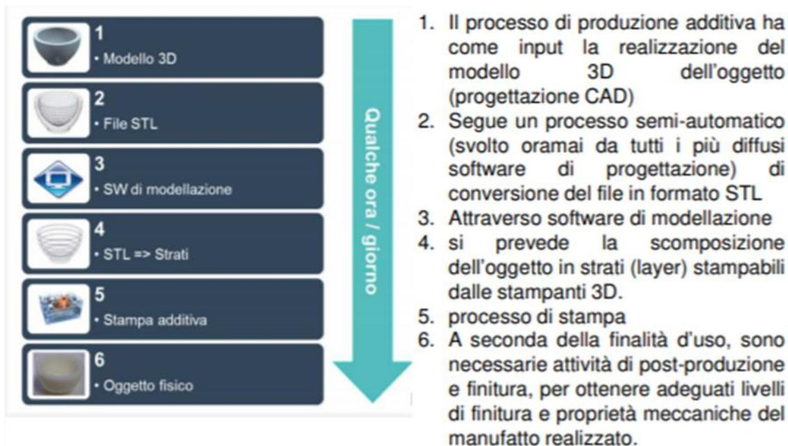
Fig.2 passaggi di produzione usando una tecnica additiva.
