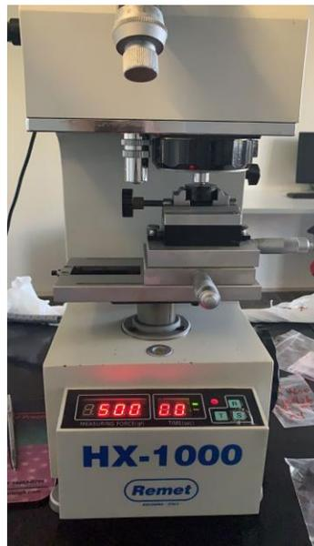
Fig.5.3.1 Microduremetro remet hx1000
