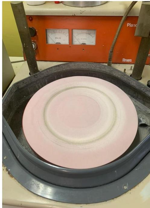
Fig 4.5.1 macchina di lappatura.
