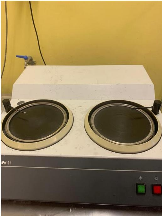
Fig. 4.5.1 macchina di lucidatura manuale.
