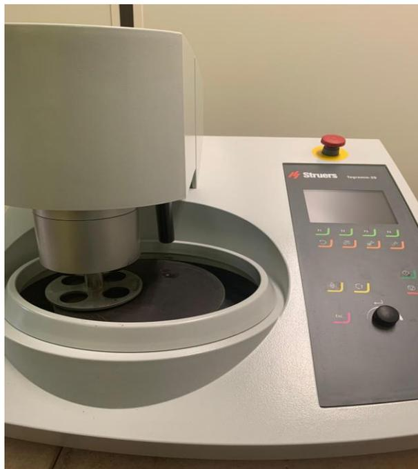
Fig. 4.5.2 macchina di lucidatura automatica.
