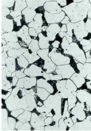
Fig.4.6a Struttura metallografica della Ferrite 500X.
