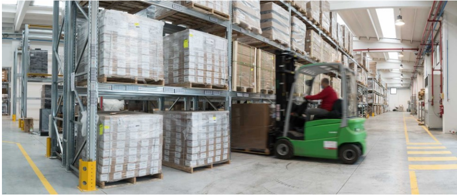
Figura 3.22 Prelievo pallet con carrello elevatore
