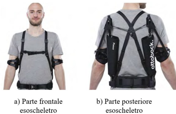
Figura 1-3: Esoscheletro Ottobock Paexo Shoulder
