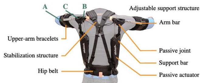
Figura 1-5: Componenti dell'Esoscheletro Ottobock Paexo Shoulder
