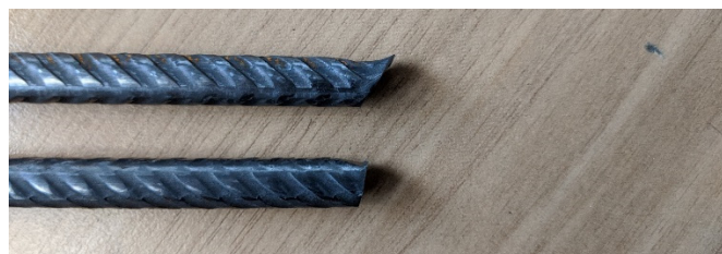
Figura 12-6 - Tondino ottenuto con coltello usurato (sopra) e nuovo (sotto)
