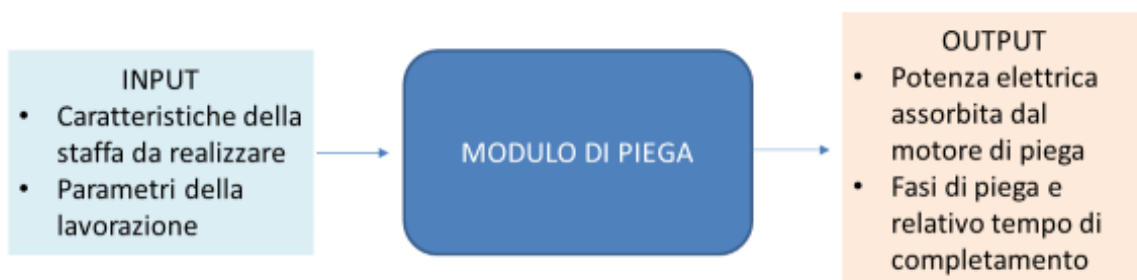
Figura 4-8 - Modello black box del modulo di piega
