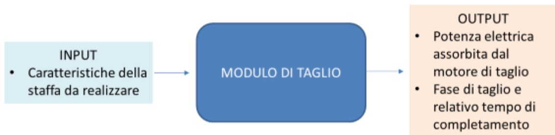
Figura 4-9 - Modello black box del modulo di taglio
