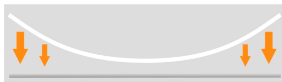
Figura 6-2 - Raddrizzatura del filo di acciaio
