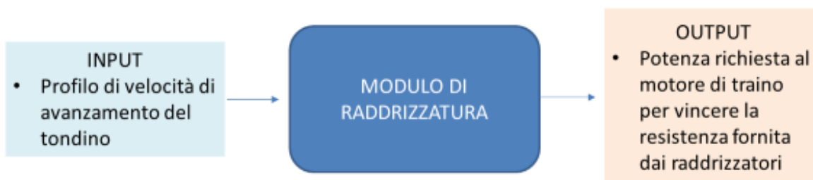
Figura 4-7 - Modello black box del modulo di raddrizzatura
