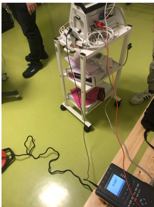
Figura 73. Verifica di sicurezza elettrica su un defibrillatore manuale.
