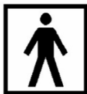
Figura 42. Simbolo di una parte applicata di tipo BF.
