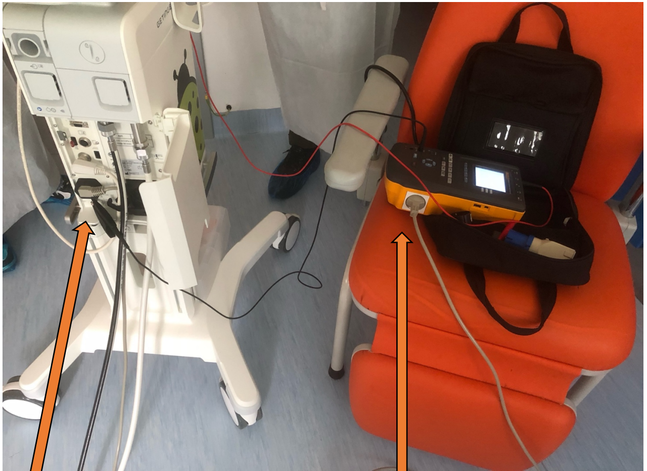
Figura 53. Verifica di sicurezza sulle parti applicate per un dispositivo di classe I.
