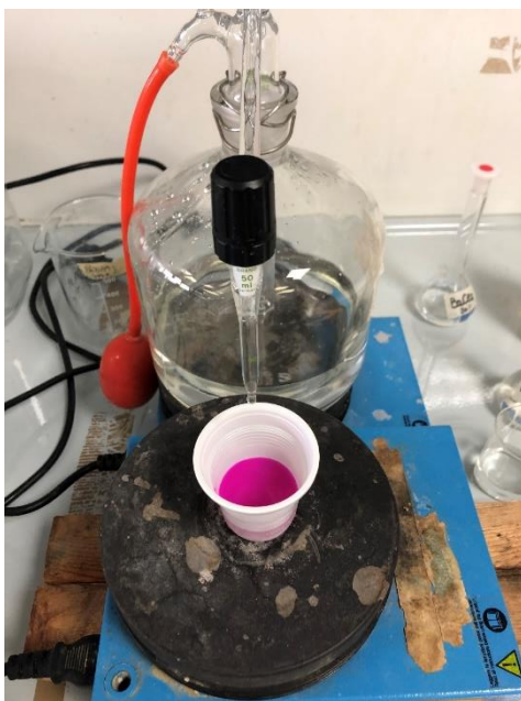
Figura 4-7: Viraggio della soluzione di NaOH 0,2 M alla titolazione con HCl 0,1 M.
