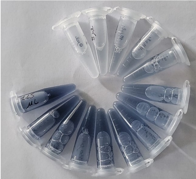
Figura 2.2: Campioni usati per la retta di taratura. Esempio di retta di taratura con concentrazione crescente di BSA che dava la colorazione da bianco a blu
