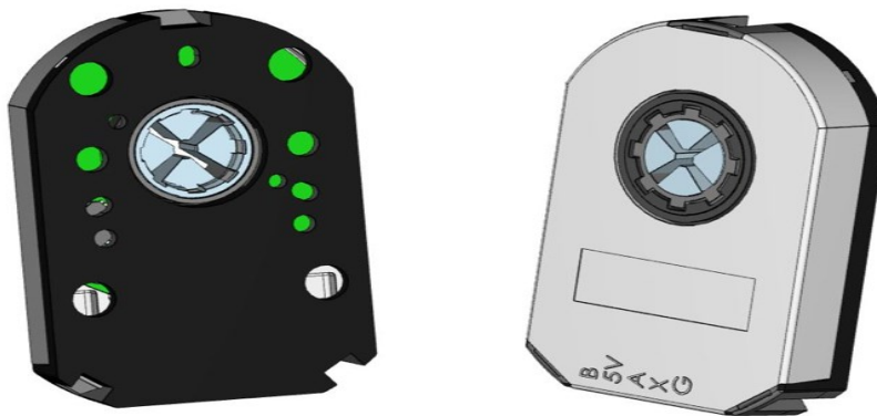
Figura 18: Visione 3D del Encoder ATM10 installato sul motore Brushless
