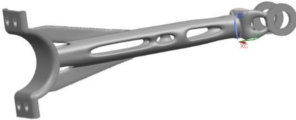
Figura 6.5: ottimizzazione della staffa in NX
