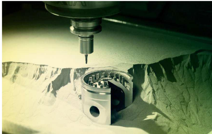
Figura 1.15: processo di Hybrid Manufacturing
