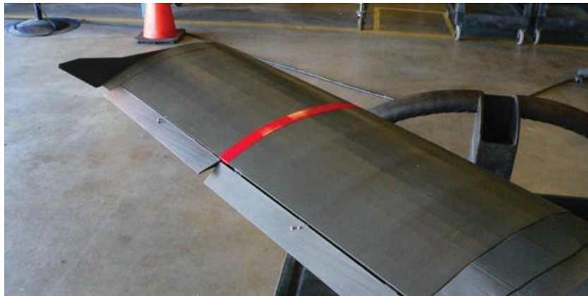
Figura 1.3: ala di un aeromobile stampata in 3D con tecnologia FDM
