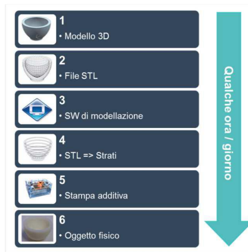
Figura 1.7: workflow per la realizzazione di una stampa 3D
