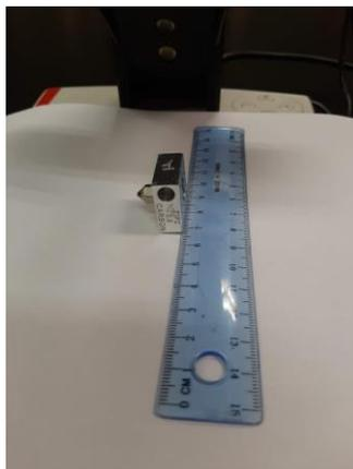
**Figura 21** Immagine raffigurante l'ugello avvitato sulla basetta. È stato utilizzato un righello per rendere il più possibile piana l'immagine dell'acquisizione
