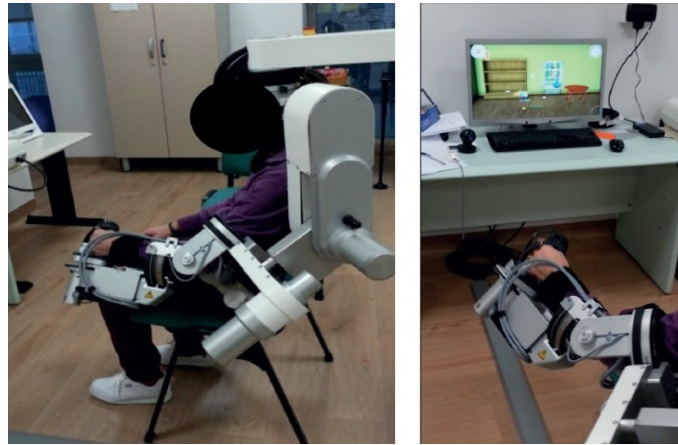
Figura 1 Dispositivo ad esoscheletro per la riabilitazione dell'arto superiore (Armeo Power, Hocoma, Svizzera).
