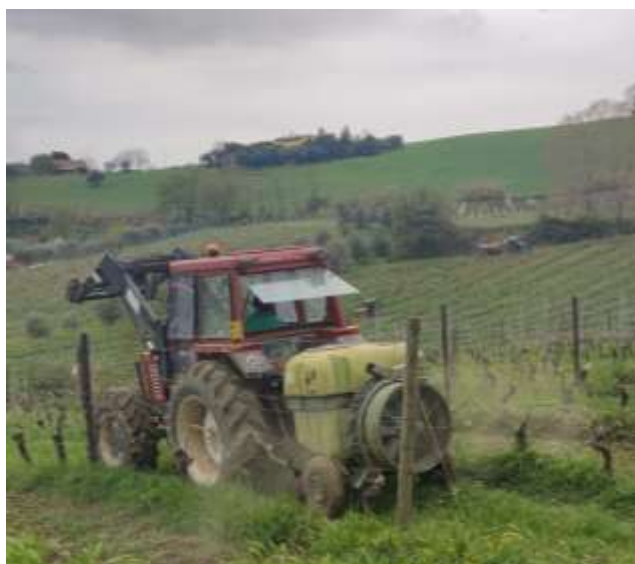
Figura 33: Distribuzione della soluzione per i trattamenti nel vigneto di Castelplanio con l'atomizzatore trainato Nobili.
