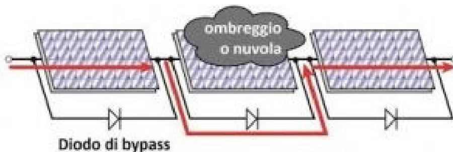
Figura 7: Percorso della corrente in caso di cella solare parzialmente ombreggiata [9]
