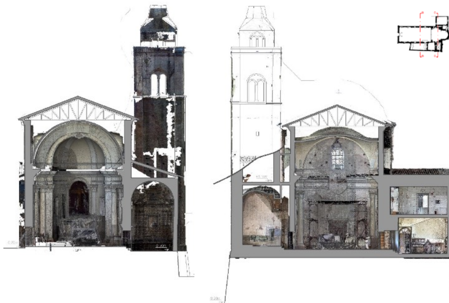
Figura 4.3.7. Sezioni trasversali B-B e C-C: sovrapposizione fra rilievo e nuvola di punti.
