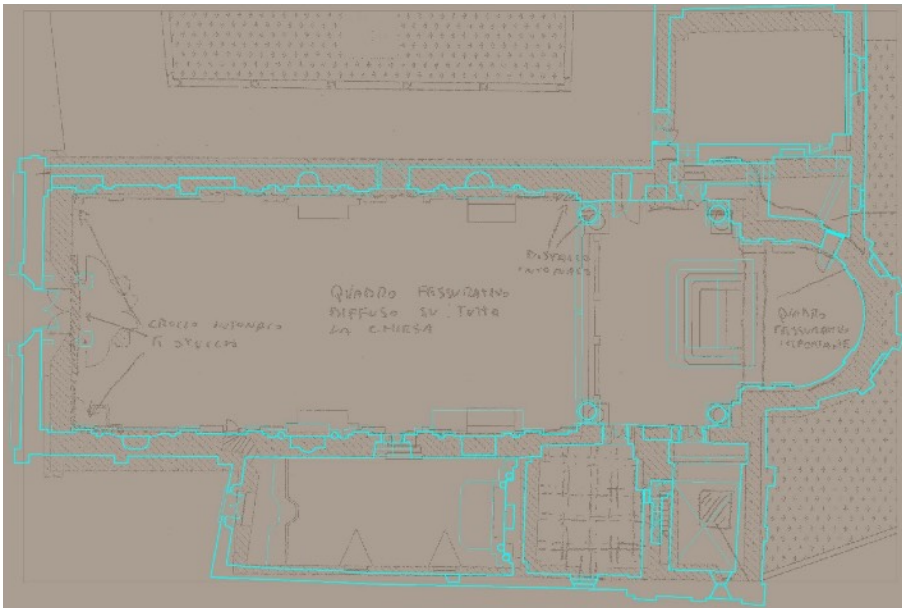
Figura 4.3.10. Confronto fra rilievo tradizionale (sfondo color tortora) e rilievo laser Scan P40 Leica.
