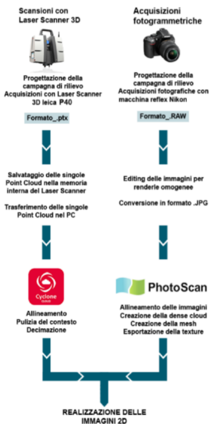
Figura 4.3.3. Algoritmo dall'acquisizione dal dato fino al modello bidimensionale.
