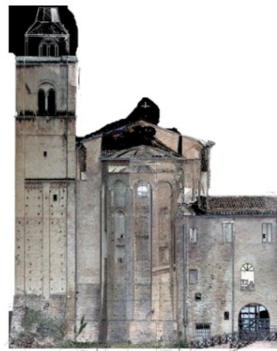
Figura 4.3.9. Prospetto Sud: sovrapposizione fra rilievo e nuvola di punti.
