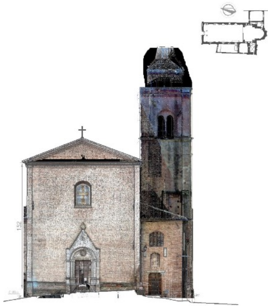
Figura 4.3.8. Prospetto Nord: sovrapposizione fra rilievo e nuvola di punti.
