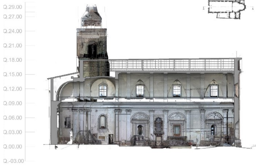
Figura 4.3.6. Sezione longitudinale: sovrapposizione tra rilievo e nuvola di punti.
