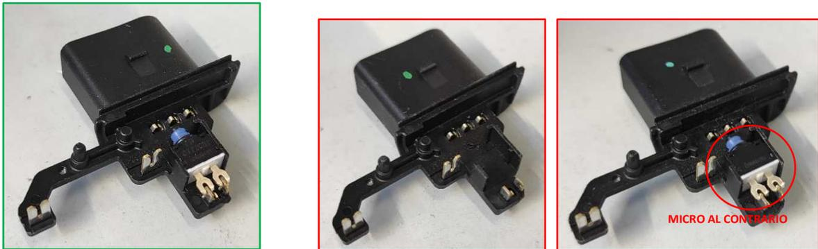
Figure 6.15. “WIP OK e NOK SCS IOE-Connettore con microswitch”.
