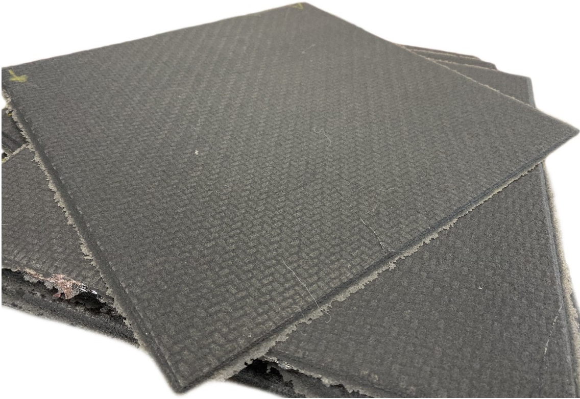
Figura 5.14: Piastre estratte dall'autoclave.
