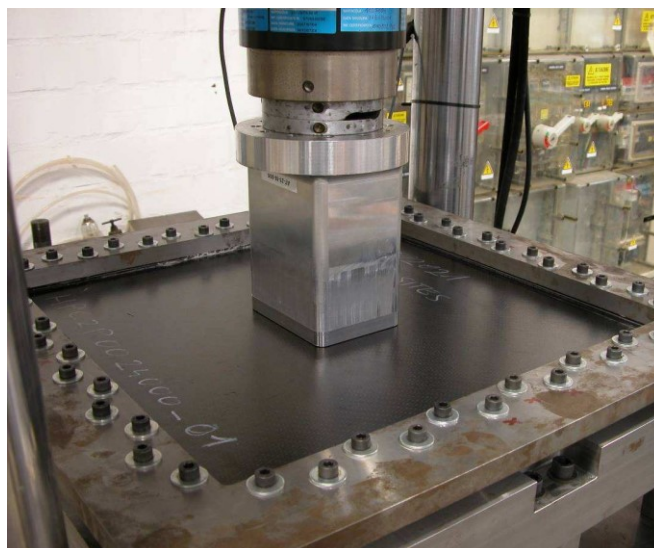
Figura 2.16: Test Pannello Secondario.
