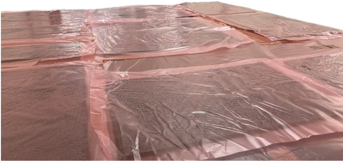
Figura 5.10: Applicazione del film distaccante.
