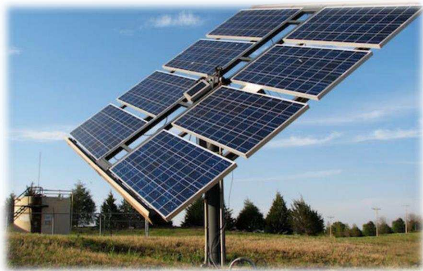
Figura 18: Inseguitore di azimut [22].
