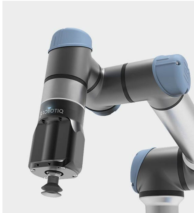
Figura 4.16: Gripper a vuoto montato su un braccio robotico.
