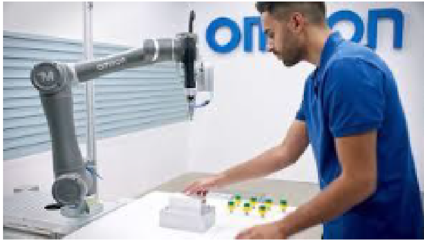
Figura 2.2: Robot ed operatore lavorano contemporaneamente sullo stesso prodotto.
