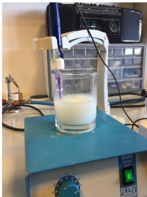
Figura 6: Determinazione della TTA; la soluzione è mantenuta in agitazione magnetica e il pH è costantemente monitorato fino al raggiungimento di un valore di 8,3.
