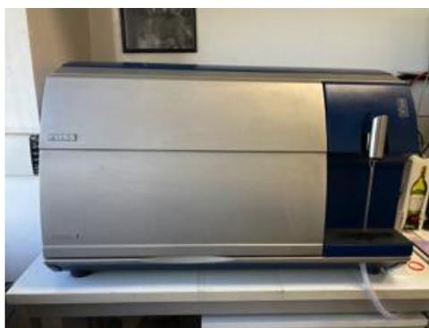
**Figura 14** - Dettaglio della cannula di aspirazione per il prelievo della soluzione da analizzare e vista frontale dell'apparecchio *Foss WineScan*.
