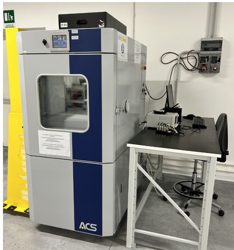
Figura 4.10: camera climatica e banco di acquisizione del laboratorio R&D di CNS.
