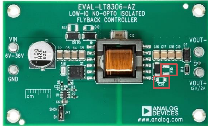
Figura 4.8: EVAL-LT8306-AZ con evidenziate le posizioni dei componenti dello snubber. [23]
