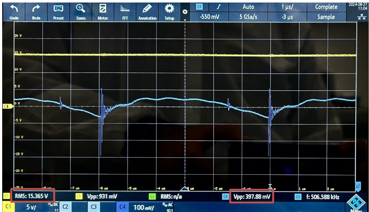
Figura 4.5: screenshot dello schermo dell'oscilloscopio durante la misura con V_{in}=28V e P_{load}= 30W .
