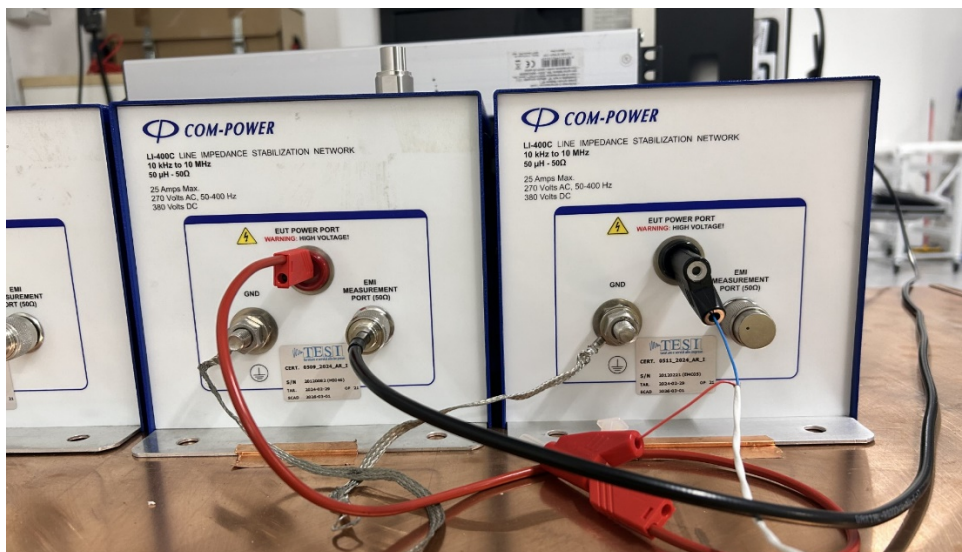
Figura 5.6: LISNs connesse all'alimentazione della scheda, polo positivo collegato all'analizzatore di spettro tramite cavo coassiale, polo negativo chiuso su adattatore a 50Ω.
