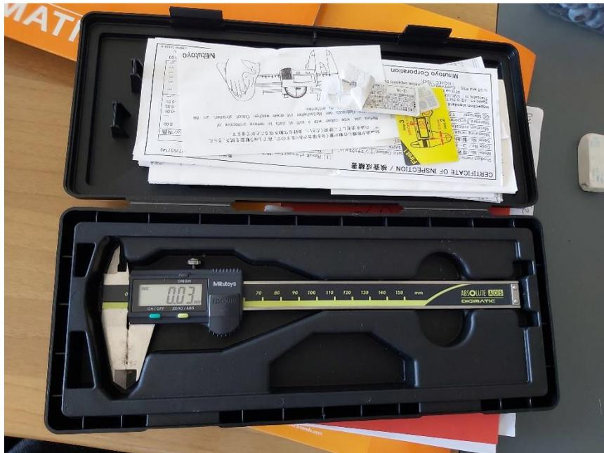
**Figura 17: Calibro per la misurazione dei mirtilli**
