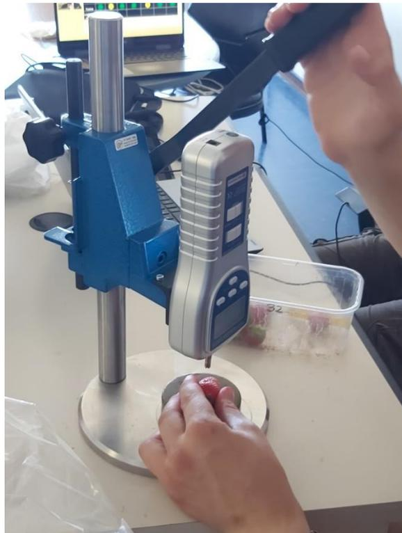
*Figura 12: Misurazione consistenza polpa con penetrometro*
