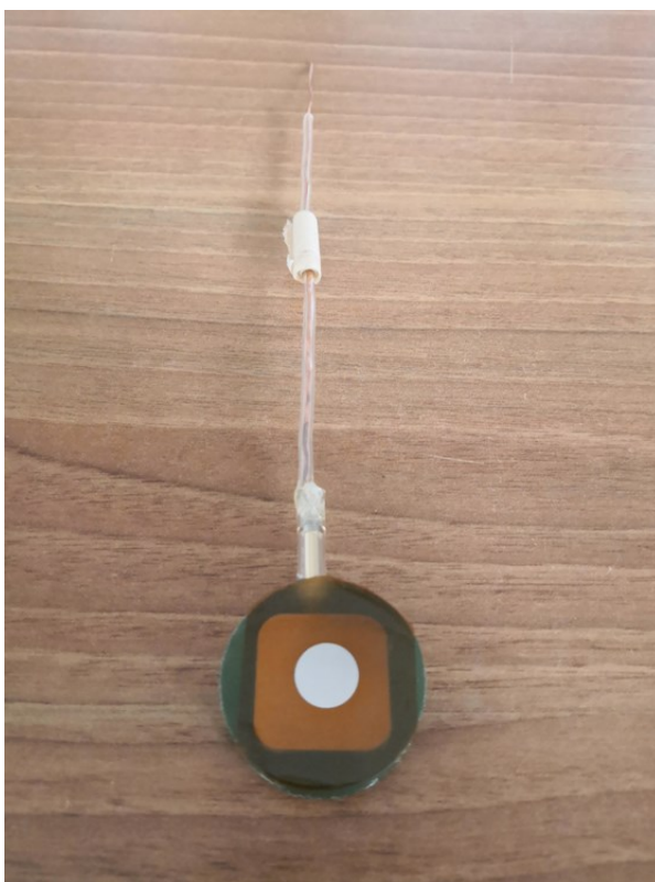
Figura 28: Provino 17-4 PH al termine delle fasi di preparazione.
