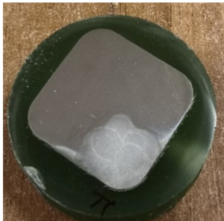
Figura 32: Provino sottoposto ad attacco metallografico.
