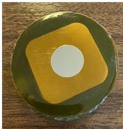
Figura 27: Campione rivestito con nastro in poliimmide.
