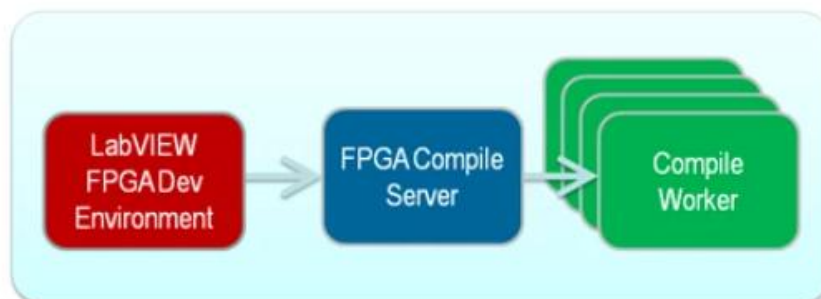
Figura 4.1: Architettura del sistema di compilazione di LabVIEW FPGA
