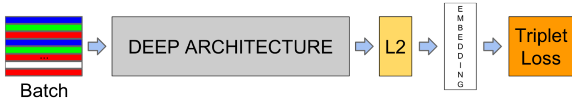
Figura 2.10: Architettura del modello [4]: schematicamente, la rete consiste in un batch di immagini dato in ingresso ad una rete neurale convoluzionale seguita da una normalizzazione L2 che restituisce l' embedding . La loss è la Triplet Loss .
