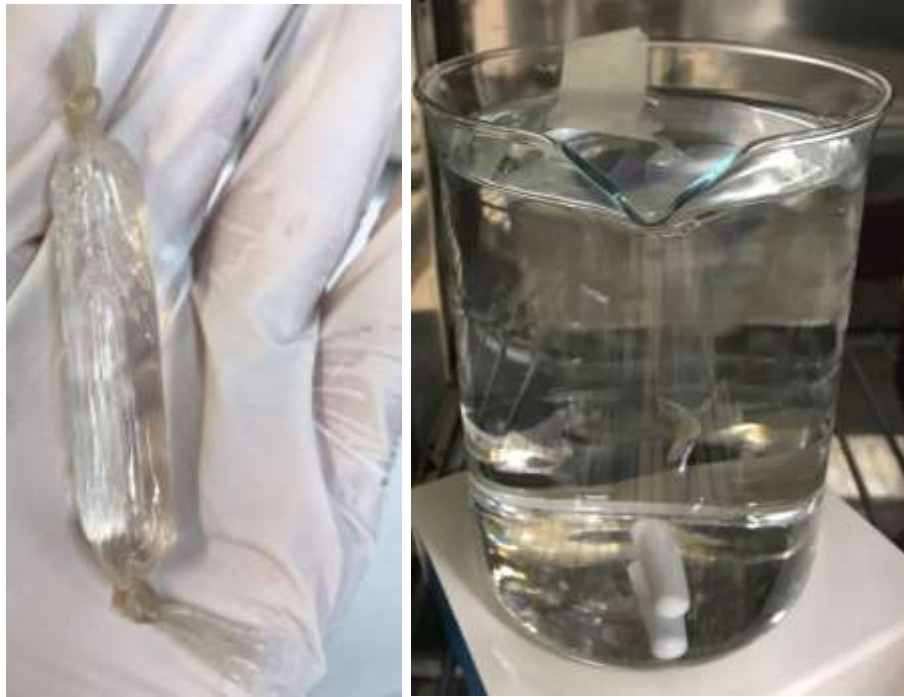
Fig.19 Immagini raffiguranti l'esecuzione di una dialisi con tubo da dialisi. A sinistra è rappresentata la 'caramella' contenente il campione che deve essere sottoposto a dialisi. A destra è raffigurato un becker contenente buffer di scambio con la 'caramella' al suo interno.
