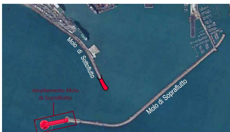
Figura 2.1 - Ampliamento molo di sopraflutto - foto aerea
