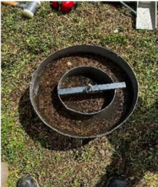
Figura 60 Inizio prova infiltrometrica
