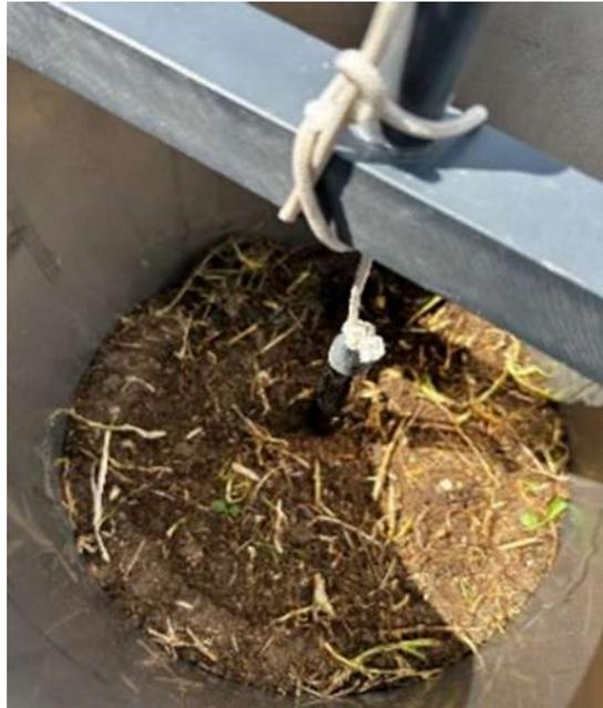
Figura 61 Posizionamento del Diver
