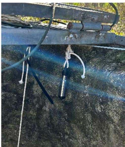
Figura 56 Posizionamento barometro
