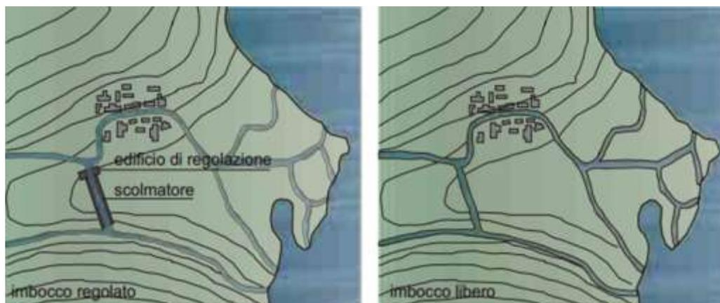
Figura 5 Scolmatore o diversivo con scarico in un recipiente (APAT Agenzia per la Protezione dell’Ambiente e per i servizi Tecnici, 2003)
