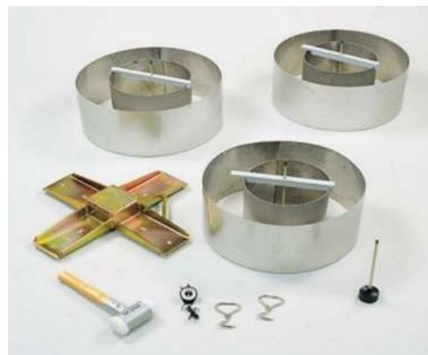
Figura 25 Set completo per test infiltrometrico, tre coppie di anelli con diverse dimensioni, una piastra in acciaio, un martello (ECOSEARCH, 2024)
