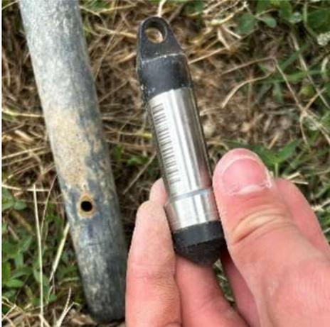
Figura 66 Sensore e tubo di protezione
