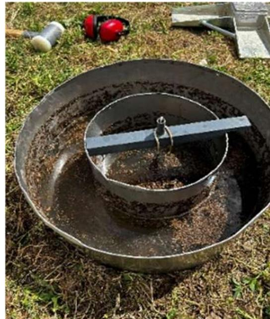
Figura 63 Termine prova infiltrometrica
