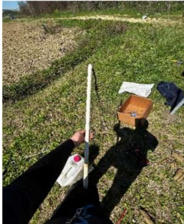
Figura 30 Sonda Drill & Drop prima del posizionamento
