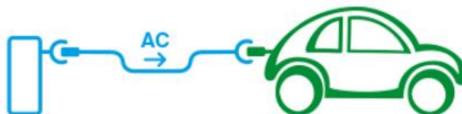
Figura 37: ricarica domestica senza PWM
