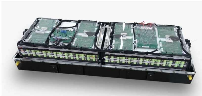
Figura 30: batteria pack autobus elettrico
