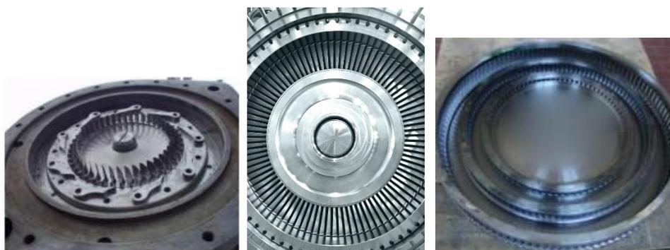
*Figura 15. Esempi di turbina centripeta, assiale e radiale (Fonte: Enea).*
