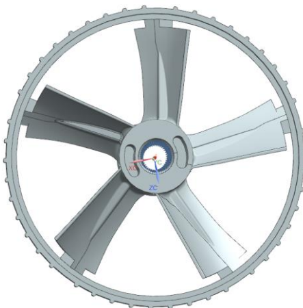
Fig. 4.41 Vincoli applicati alla simulazione modale per la ventolina di raffreddamento
