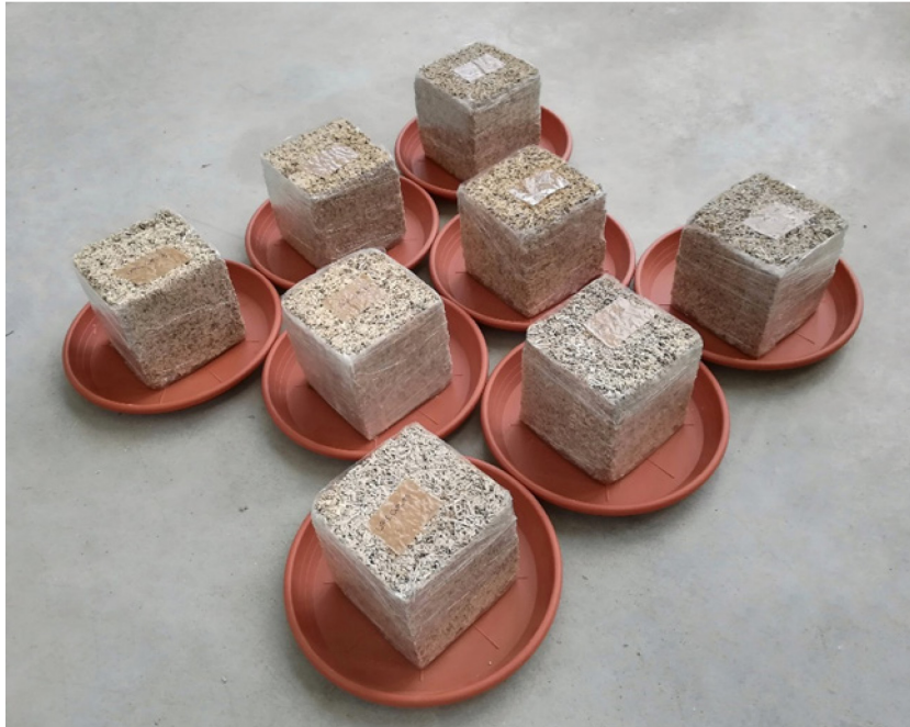
Foto 3: provini rivestiti di cellophane.
