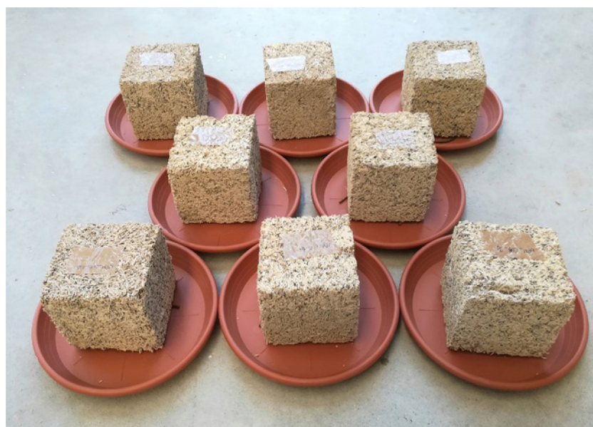
Foto 2: provini essiccati e stabilizzati.
