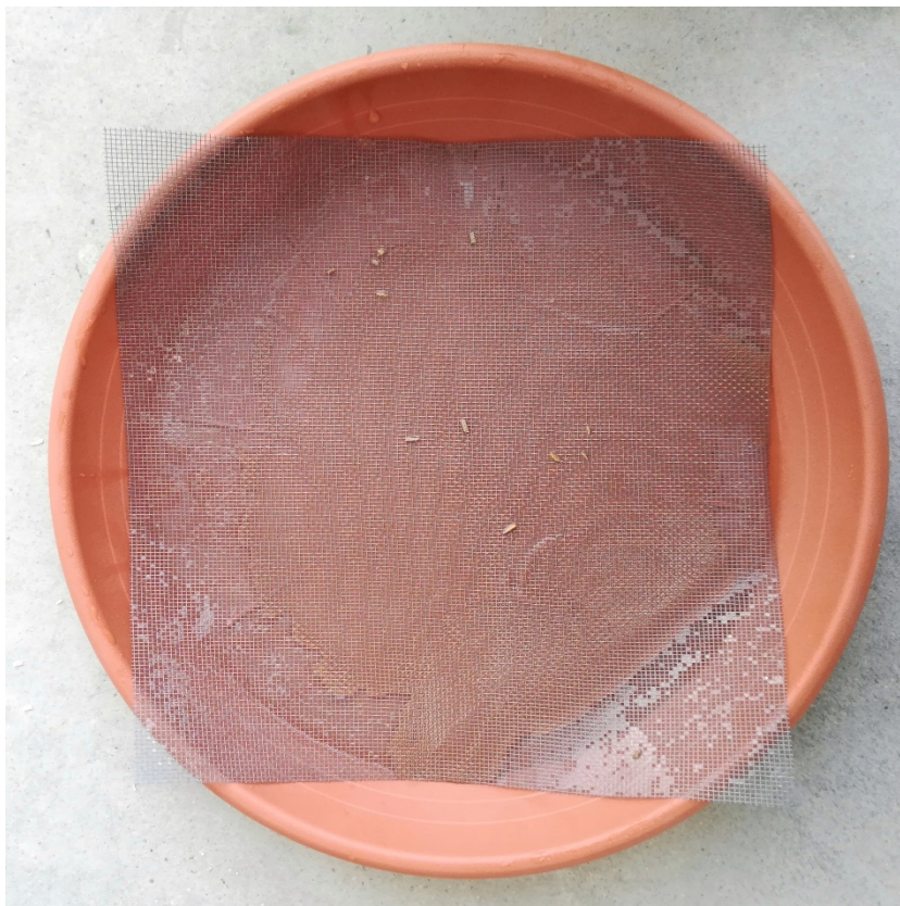
Foto 8: esempio del quantitativo di materiale perso da ciascun provino durante la prova.
