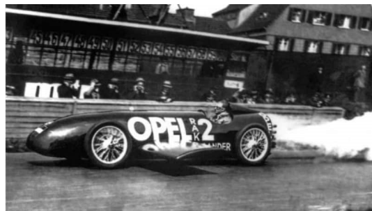
Figura 1.7: Opel Rak2, primo mezzo dotato di superfici alari
