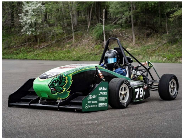
Figura 3.2: Una Formula SAE senza ala posteriore
