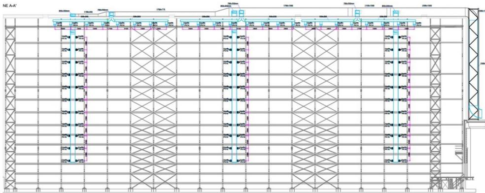
*Figura 3.4 – Magazzino in sezione con dettaglio canali di mandata*
