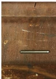
Fig. 13: traccia di incisione lasciata dagli impulsi laser durante la scansione per il L280 difetto testa
