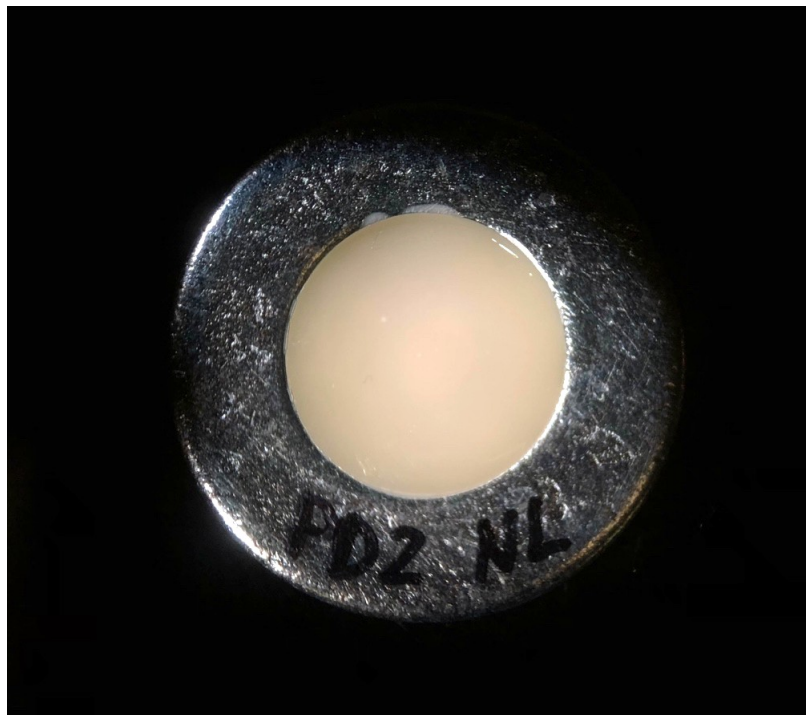
Figura 8 Anello in metallo con all'interno un campione di composito
